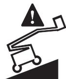
指示灯亮说明机器不平。该灯变亮时将响起倾斜警报。将机器移动到坚实的水平地面上。
