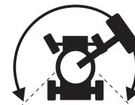
注意：使用驱动启用系统时，机器可按行驶和转向控制手柄移动的相反方向行驶。
